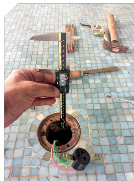
**Figura 5 – Verificação da espessura da laje pela tomada do 1º pavimento**
