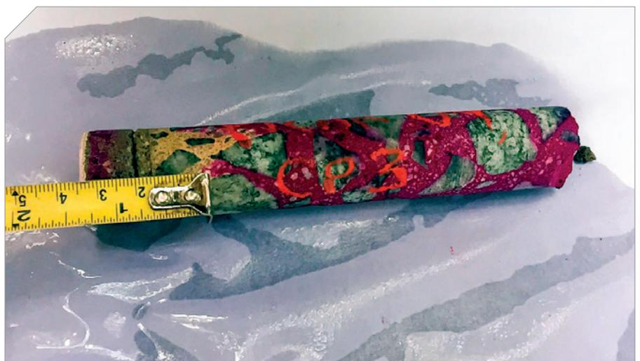
Figura 7 – Ensaio para verificação da profundidade de carbonatação
