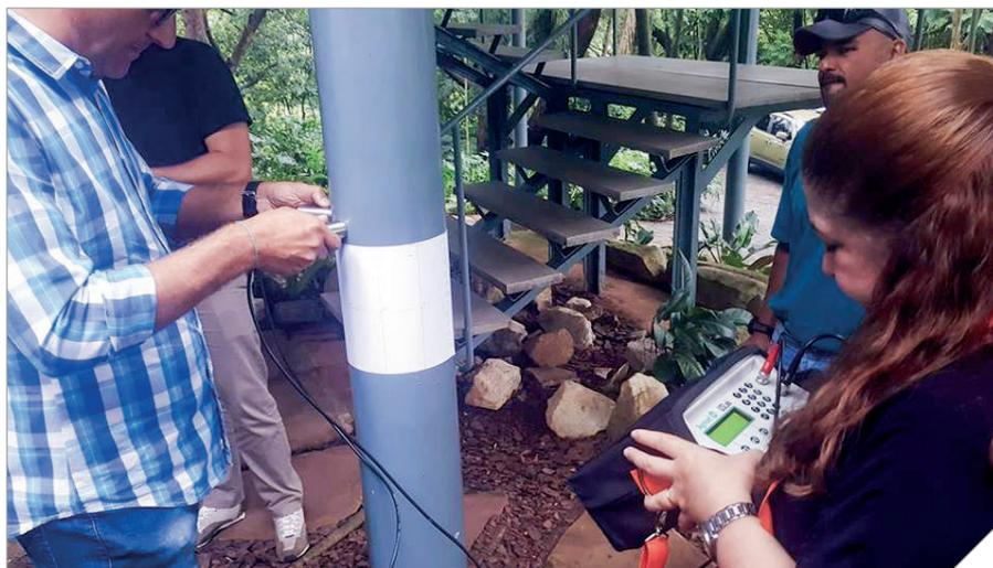
**Figura 3 – Execução de ultrassonografia nos pilares**
